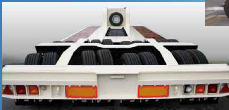
36t 2軸 16輪セミトレーラー(連動ステアリング付き) 2-axle 16-wheel semi-trailer (with steering system)
