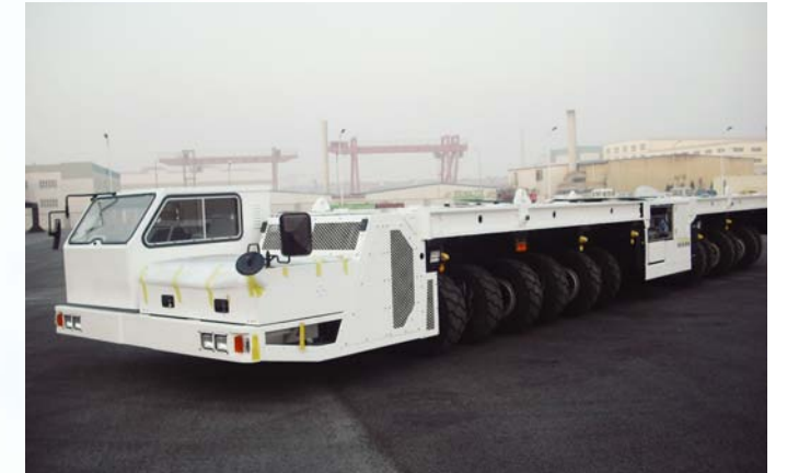
ノンスリップ制御付きキャリヤ(未舗装傾斜試験 80t 19%) Nonslid-controlled carriers (Unpaved slope test, 80 tons: 19%)
