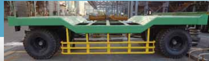
33t 2軸 8輪フルトレーラー 2-axle 8-wheel full-trailer
